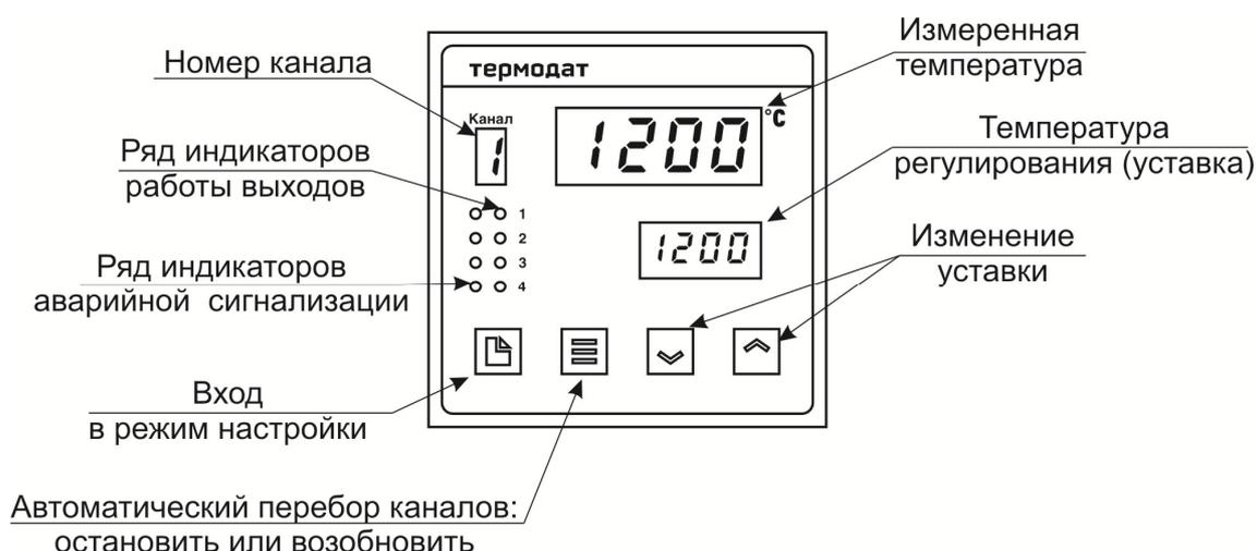
Рисунок 2 – Описание индикаторов и кнопок управления прибора
