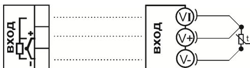
Рис 5 Схема подключения термометра сопротивления к входу прибора
