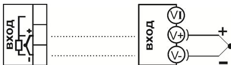
Рис 4 Схема подключения термопары к входу прибора.
