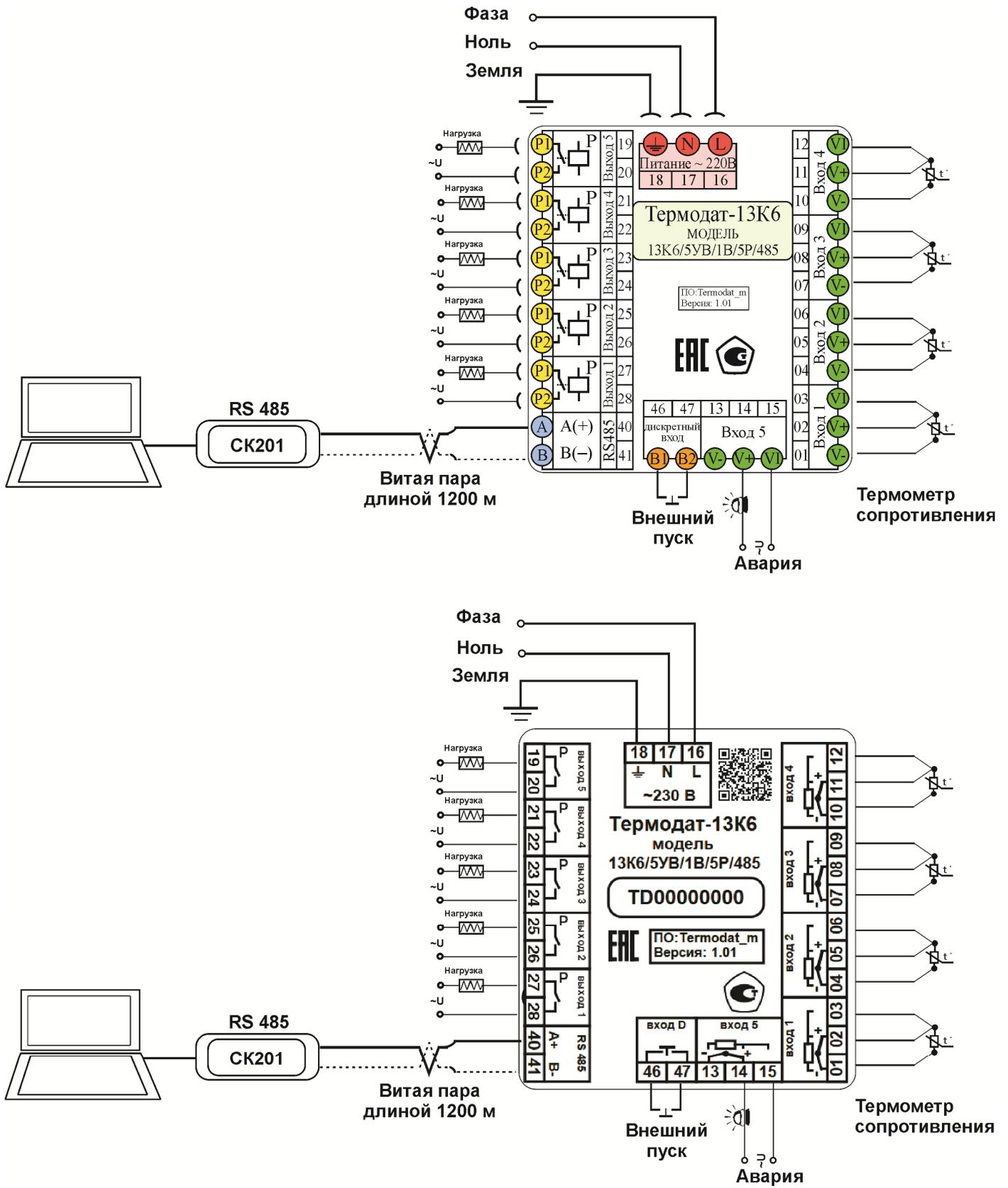
Рисунок 11 – Схема подключения прибора по 5 каналам
