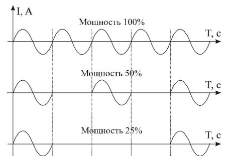
При методе **равномерно распределенных рабочих сетевых периодов (РСП)** ток через нагрузку периодически включается на один или несколько сетевых периодов. Мощность нагревателя испытывает меньшие колебания во времени, чем при использовании ШИМ. Этот метод очень хорош в лабораторных условиях при малых мощностях нагревателя. Не используйте метод при мощностях более 5 кВт. Недопустимо использование метода РСП при индуктивной нагрузке.
