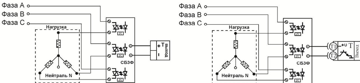
Управление трехфазной нагрузкой с помощью силовых блоков.
