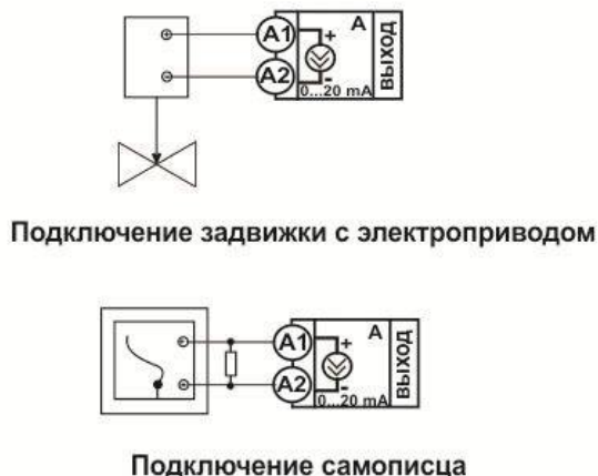
Рисунок 5 – Схемы подключения аналогового выхода
