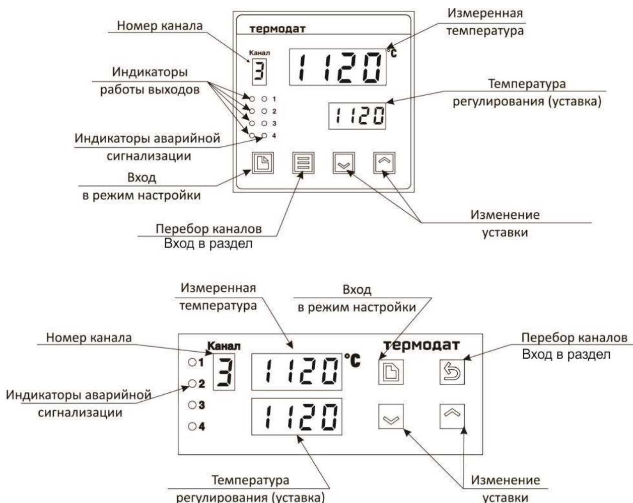
Рисунок 3 – Описание индикаторов и кнопок управления приборов 11М6/... и 11М6-6U/...
