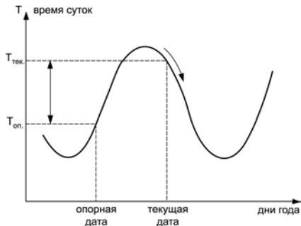
Рисунок 6.2 – График коррекции включения и выключения по восходу и заходу солнца
