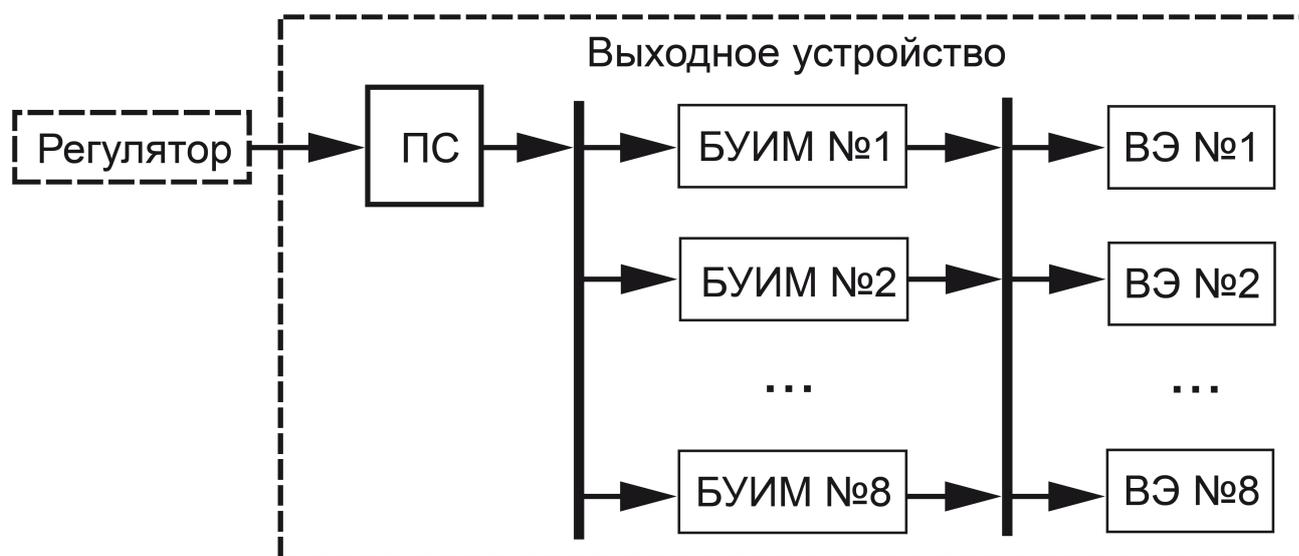
Рисунок 9.31 – Структурная схема Выходного устройства прибора
