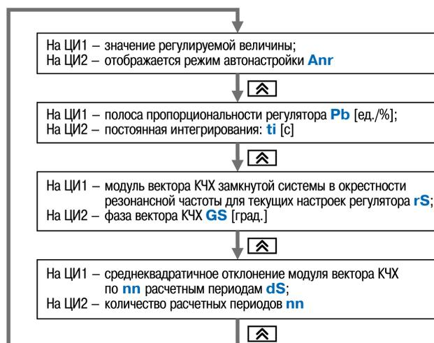
Рисунок 9.20 – Схема переключения индикации в режиме Автонастройки
