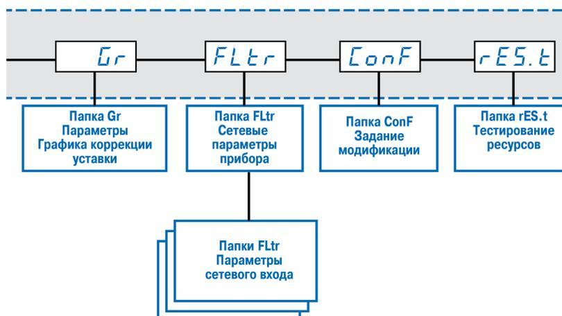
Рисунок 8.14 – Общая схема задания параметров прибора (продолжение)
