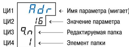
Рисунок 8.10 – Показания цифровых индикаторов при задании параметров
