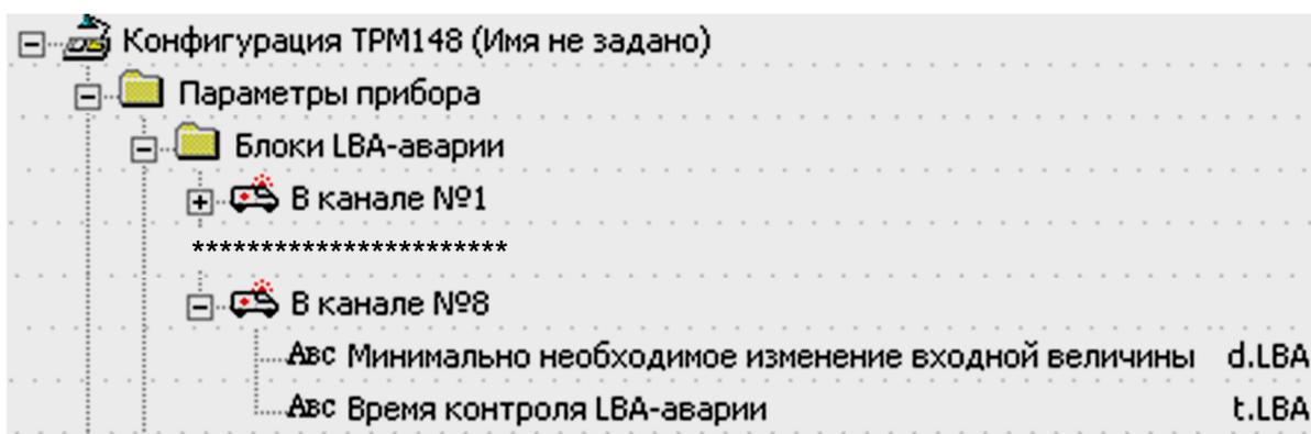
Рисунок 9.30 – Конфигуратор. Контроль LBA
