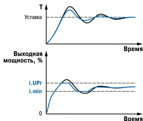
Рисунок 9.17 – ПИД-регулирование
