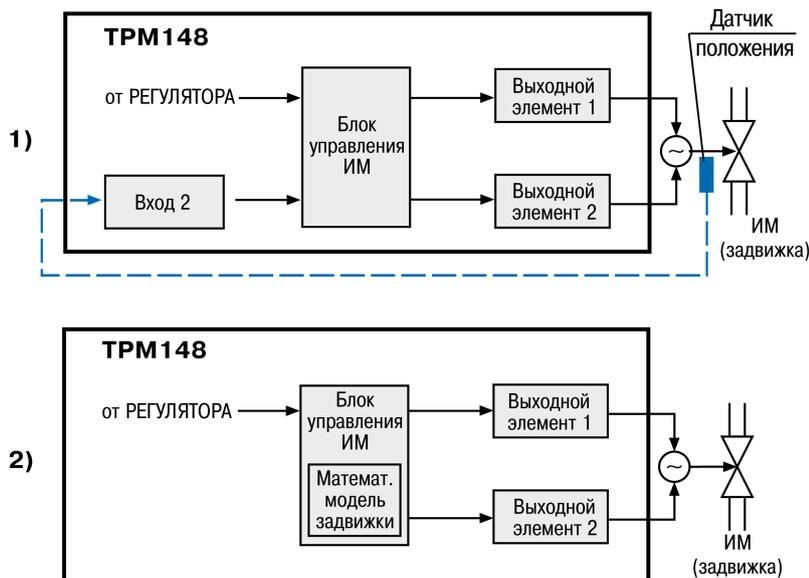
Рисунок 9.35 – Управление 3-х позиционным ИМ: 1 – с датчиком положения; 2 – без датчика положения.
