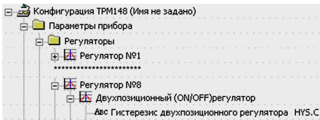
**Рисунок 9.21 – Конфигуратор. Настройка двухпозиционного регулятора**
