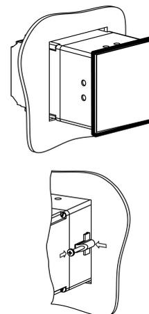
Рисунок 4.1 – Монтаж прибора
