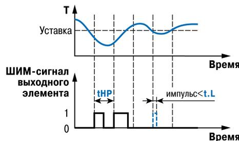
**Рисунок 9.44 – Точность регулирования при разной частоте управляющих импульсов**
