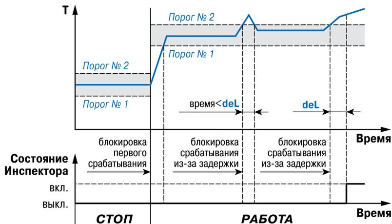
Рисунок 9.56 – Пример логики работы и блокировок срабатывания Инспектора
