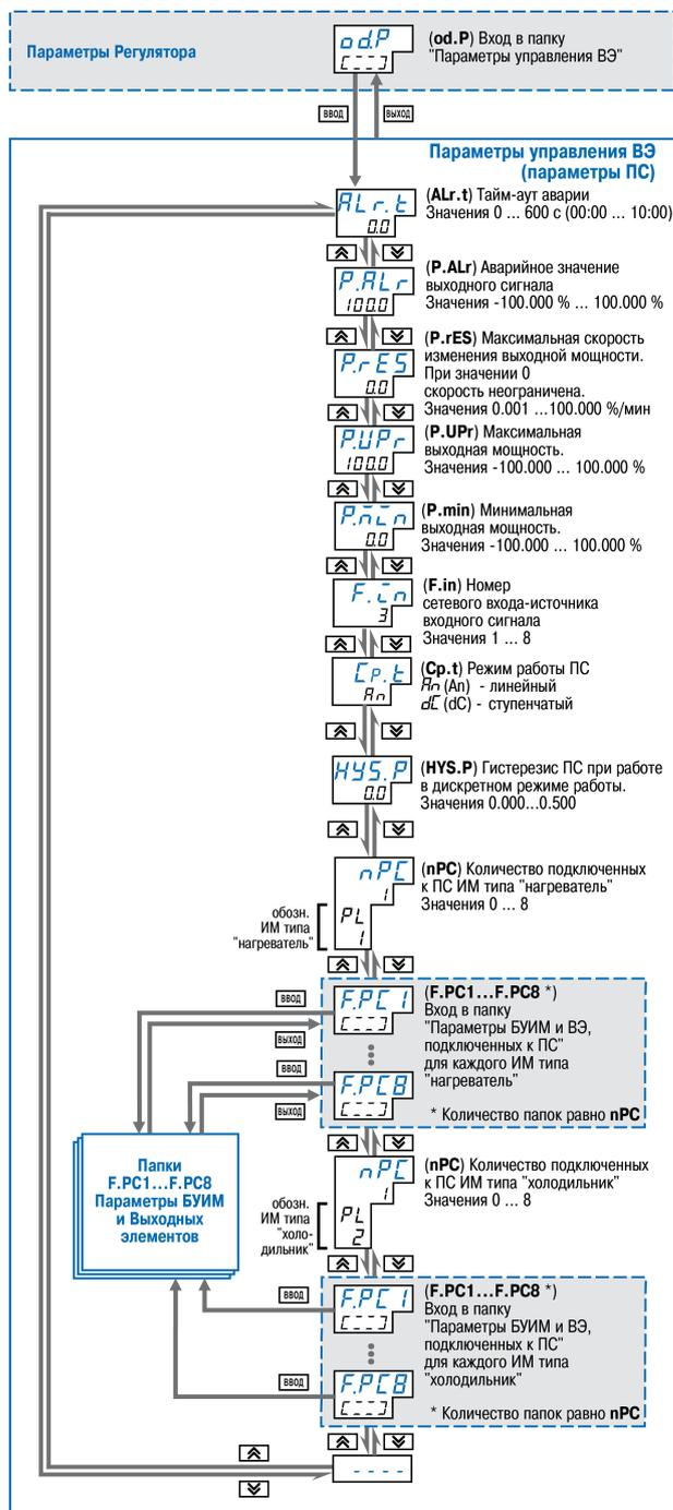
Рисунок 8.22 – Схема задания параметров управления ВЭ
