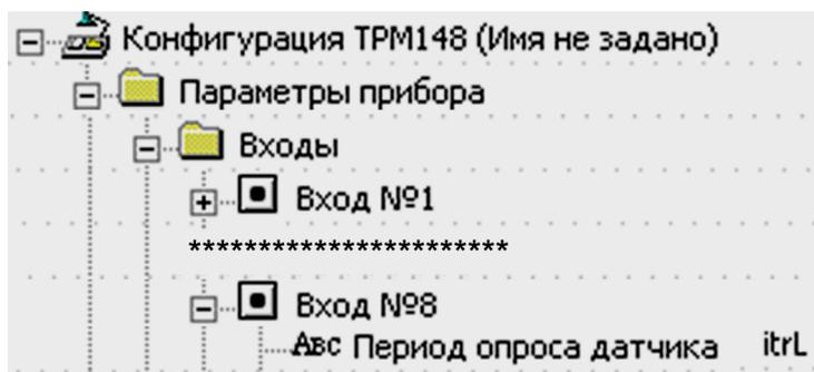
Рисунок 9.7 – Конфигуратор. Задание периода опроса датчика
