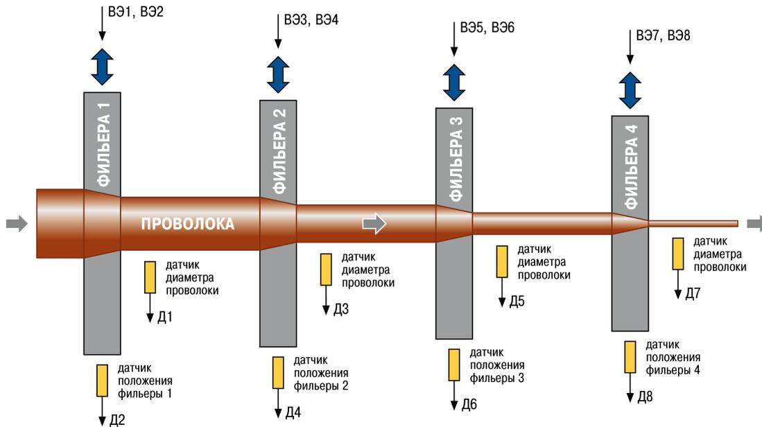
**Рисунок 7.8 – Использование 8-канального регулятора ТРМ148 3-ой модификации в управляемой автоматизированной системе из четырех фильер для получения проволоки**
