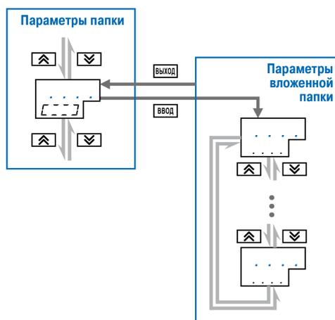
Рисунок 8.12 – Схема работы с вложенной папкой
