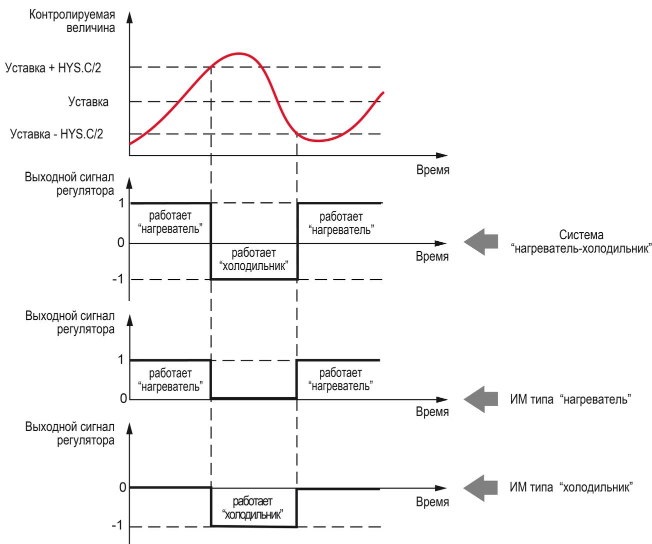
**Рисунок 9.22 – Принцип работы Двухпозиционного регулятора**
