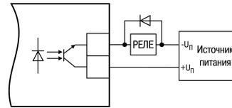
Рисунок 5.12 – Схема подключения нагрузки к ВУ типа К
