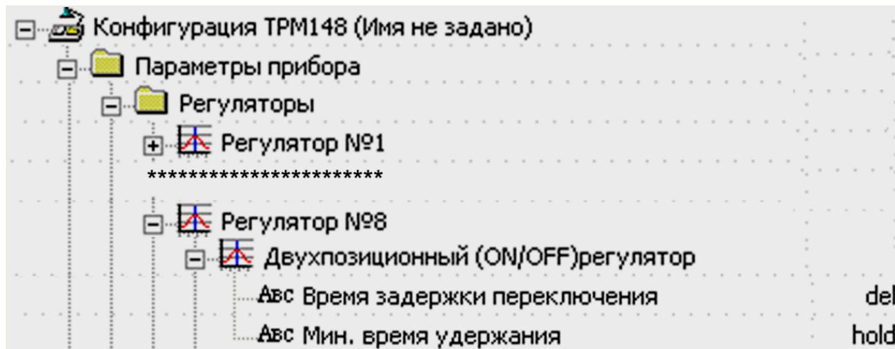
Рисунок 9.27 – Конфигуратор. Задержки и удержания
