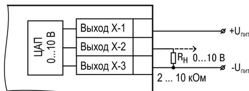
Рисунок 5.20 – Схема подключения нагрузки к ВУ типа У
