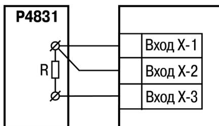
Рисунок 10.1 – Подключение при юстировке ТСМ и ТСП
