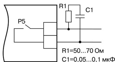
Рисунок 5.10 – Схема подключения нагрузки к ВУ типа Р
