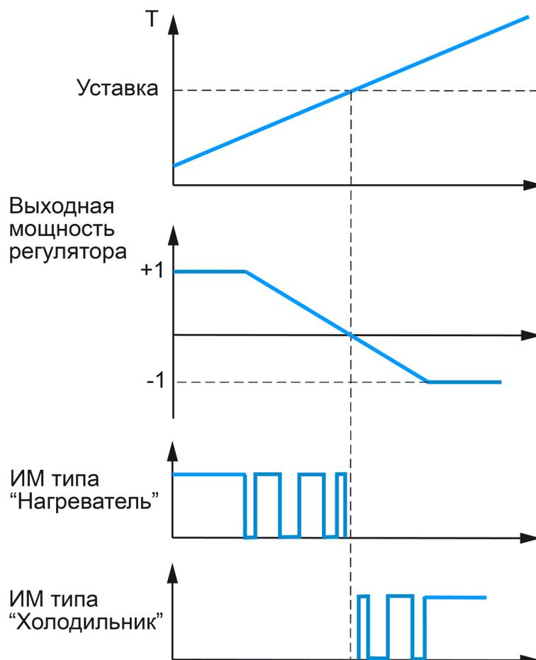
Рисунок 9.16 – Принцип формирования ШИМ-сигнала для системы «нагреватель-холодильник»
