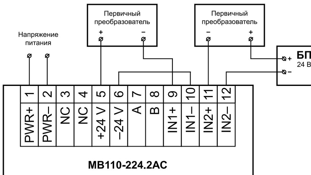
Рисунок 5.3 – Подключение к прибору двухпроводных первичных преобразователей
