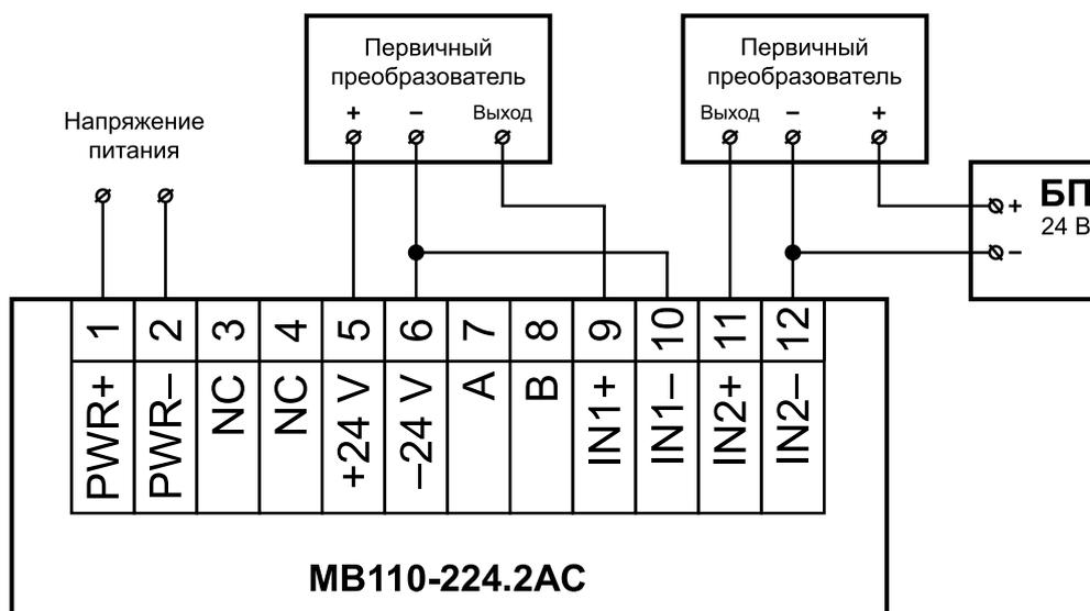
Рисунок 5.4 – Подключение к прибору трехпроводных первичных преобразователей
