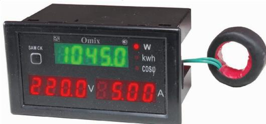
Мультиметр однофазный Omix P74-M3-1 предназначен для измерения и индикации силы тока, напряжения, активной мощности, электрической энергии и коэффициента мощности в однофазных цепях переменного тока.
