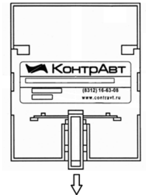
Рисунок 4 – Способ установки блоков при монтаже
