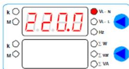
Рис. 17– Пример работы прибора. Режим отображения среднего фазного напряжения
