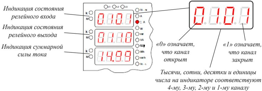
Рис. 15 – Пример работы прибора. Режим отображения суммарной силы тока.
