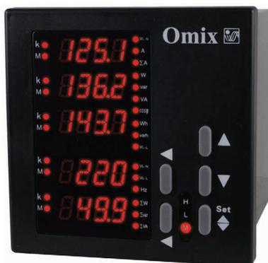
Omix P99-MZ-3-0.5 – трехфазный мультифункциональный прибор, измеряющий фазные напряжения, линейные напряжения, силу тока, суммарную силу тока, суммарную активную, реактивную и полную мощность, частоту и коэффициент мощности. Приборы выпускаются в трех модификациях:
