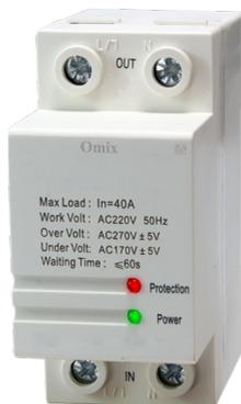
Прибор для контроля однофазного напряжения и защиты оборудования от пониженного и повышенного напряжения в сети. Встроенное мощное реле размыкает цепь нагрузки при выходе напряжения за предустановленные пороговые значения (~170 В и ~270 В).
