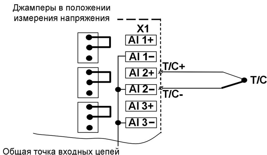
Рисунок 5.4 – Пример подключения термопары ко второму измерительному каналу
