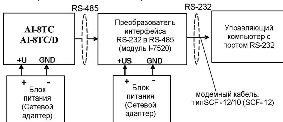
Рисунок 6.1 – Схема подключения модуля для работы
