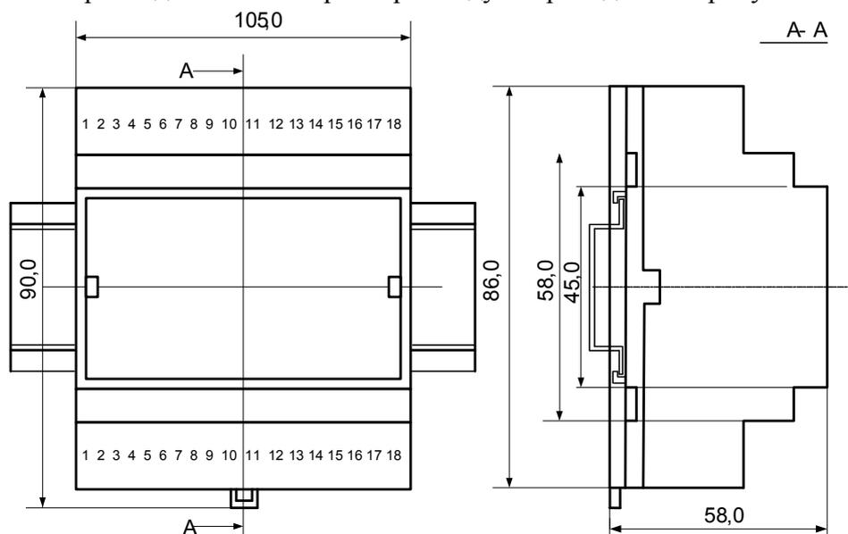
Рисунок 5.1 – Габаритные и присоединительные размеры модуля
