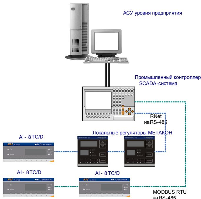
Модули серии MDS обеспечивают периферийный ввод-вывод аналоговых и дискретных сигналов. Модули MDS AI-8TC и AI-8TC/D входят в состав серии MDS и имеют 8 независимых каналов измерения аналоговых сигналов термопар, унифицированных сигналов напряжения и тока, осуществляют передачу данных в управляющий компьютер (контроллер).
