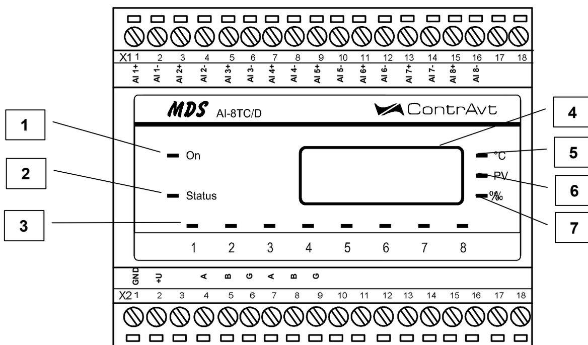
Рисунок 4.1 – Вид модуля со стороны передней панели
