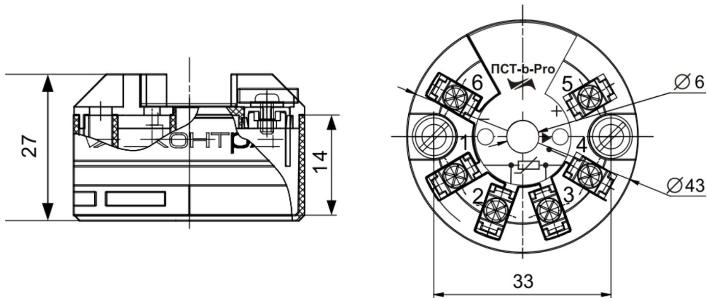
Рисунок 1 – Внешний вид и габариты преобразователя
