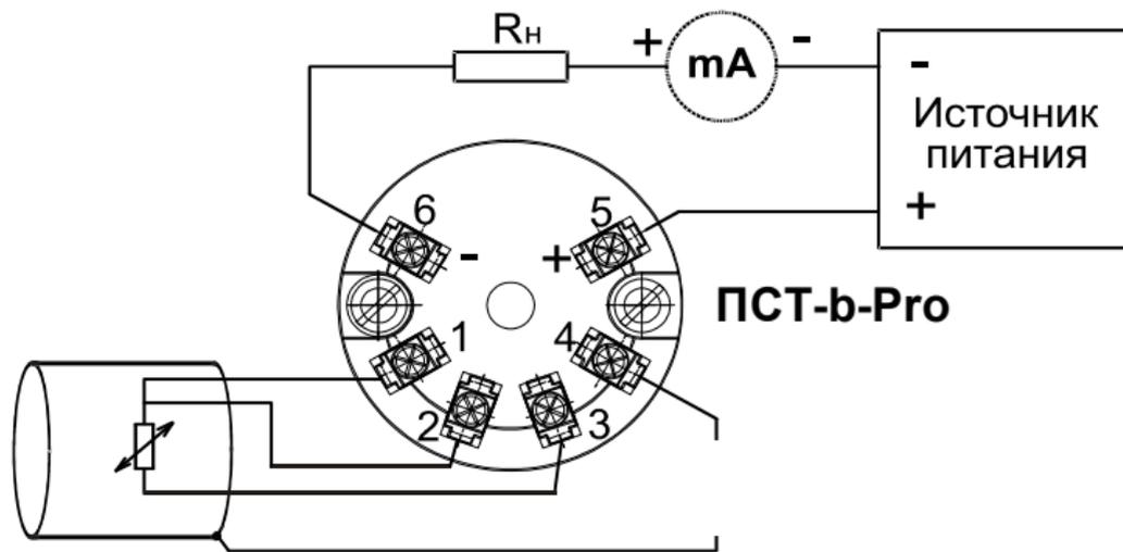
Рисунок 26 – 3-х проводная схема подключения ТС
