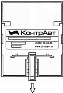
Рисунок 5 – Способ установки блоков при монтаже
