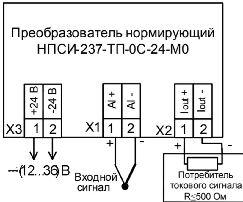
Рисунок 6 – Электрическая схема подключения преобразователя
