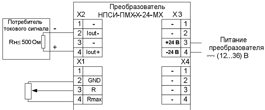
Рисунок 5 – Электрическая схема подключения преобразователя НПСИ-ПМХ-Х-24- МХ
