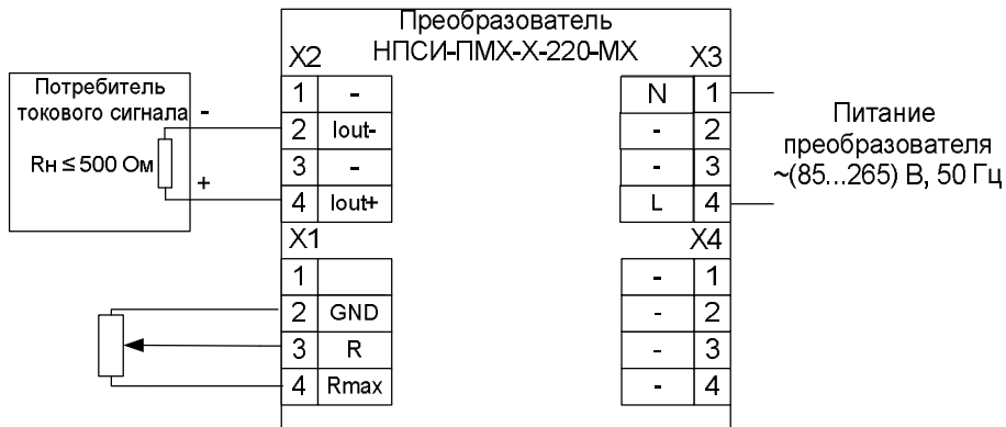
Рисунок 4 – Электрическая схема подключения преобразователя НПСИ-ПМХ-Х-220- МХ
