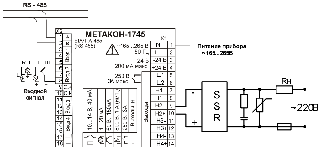
Рисунок 12 – Электрическая схема подключения твердотельного реле к прибору МЕТАКОН-1745-4К-У-1
