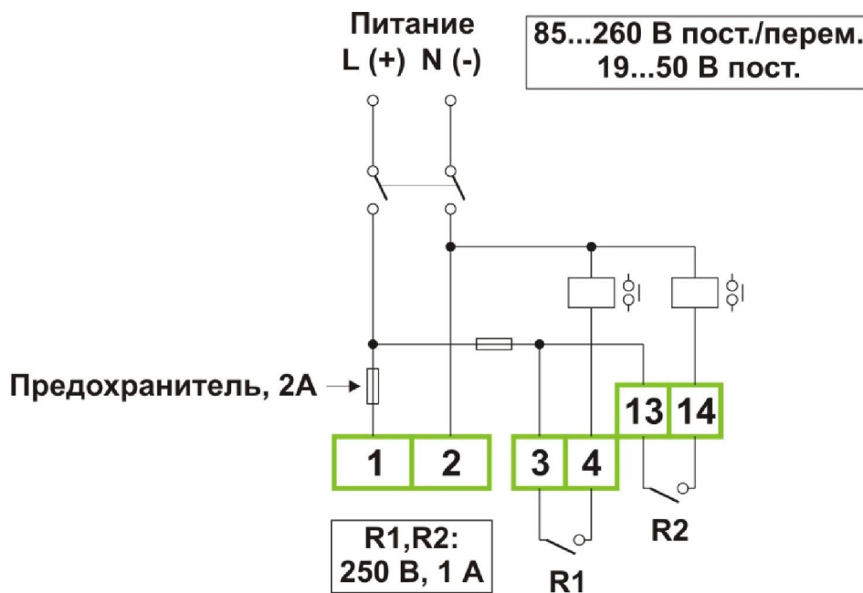
Рисунок 2.10. Пример включения реле (тип – “сухой контакт”).
