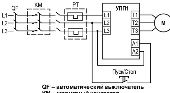
**Рисунок 2 - Схема подключения УПП1**
