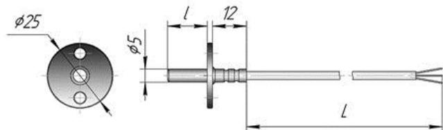
Рисунок 1 – Термопреобразователь сопротивления в конструктивном исполнении К2Ф
