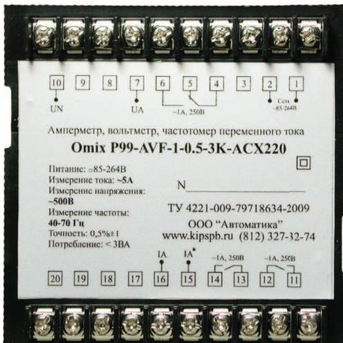
Рис. 7 – Задняя панель прибора
