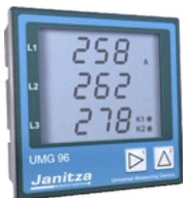
UMG 96 предназначен для измерения и записи электрических параметров (напряжение, ток, частота, активная/реактивная/полная мощность,  $\cos \phi$ , активная/реактивная энергия) в электрических сетях 50/60 Гц. Измерение сконфигурировано для трехфазных систем с центральным проводником (электрические сети TN и TT). На частоте электрической сети 50 или 60 Гц частота сканирования измерений, которое происходит один раз в секунду, составляет 2,5 или 3,0 кГц.
